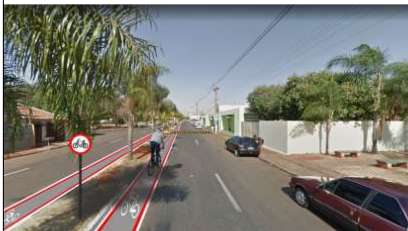
Av. Hideo Takada – Situação Proposta com Tratamento de Ciclofaixa junto ao Canteiro Central
