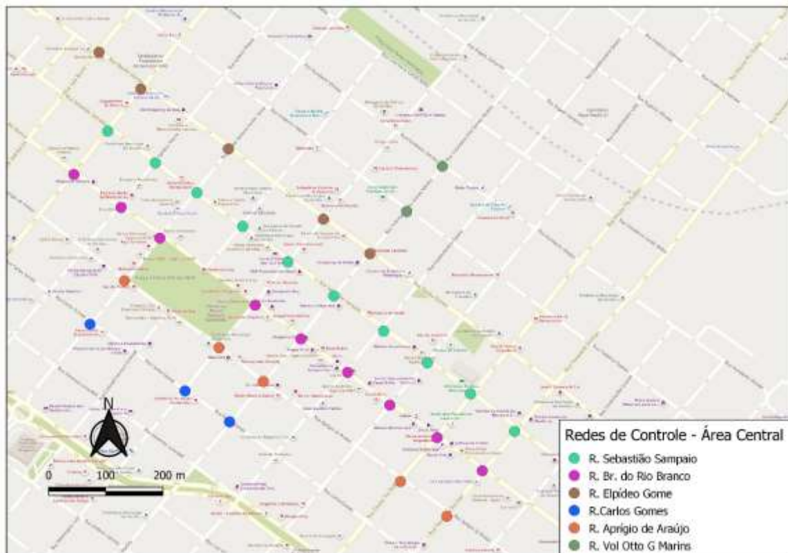
Figura 2: Redes de Controle Semafórico na Área Central de Sertãozinho Fonte: PMS – elaborado por MDN
