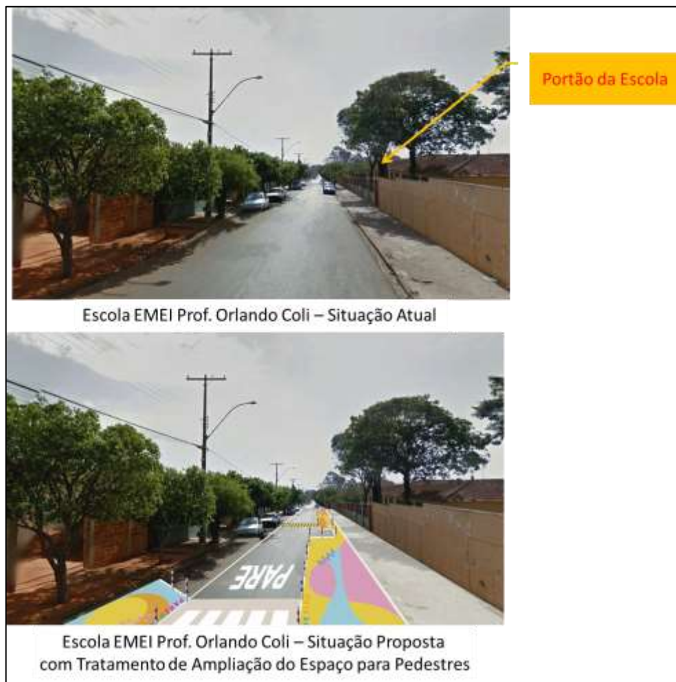
Figura 8 – Ilustração do Tratamento Proposto na via onde se localiza o portão da Escola Fonte: Elaborado por MDN
